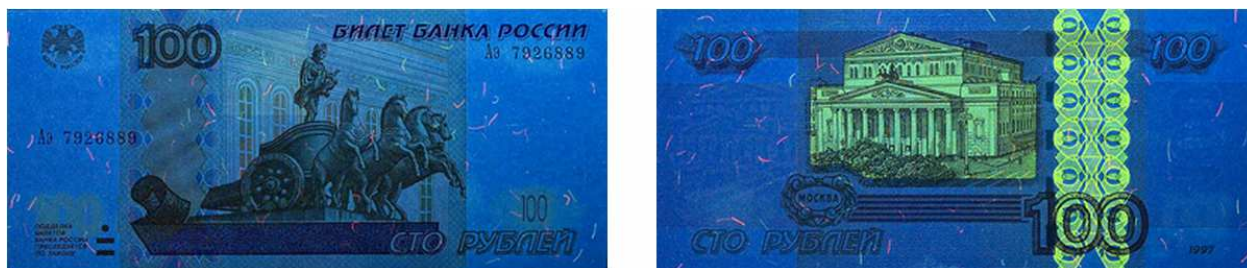
Рис. 3 - Изображение люминесценции банкноты под воздействием ультрафиолетового излучения
