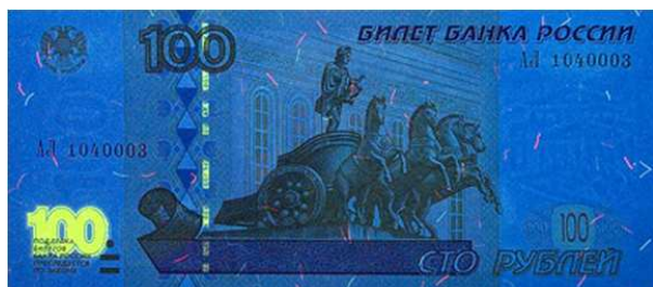
Рис. 3 - Изображение люминесценции банкноты под воздействием ультрафиолетового излучения
