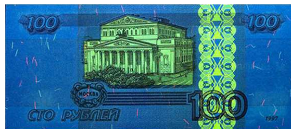
Рис. 3 - Изображение люминесценции банкноты под воздействием ультрафиолетового излучения
