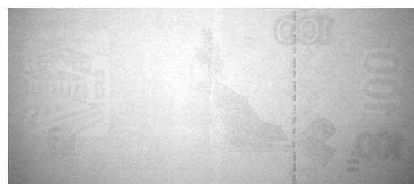
Рис. 2 - Изображение банкноты в инфракрасном диапазоне спектра
