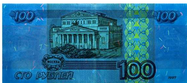
Рис. 3 - Изображение люминесценции банкноты под воздействием ультрафиолетового излучения
